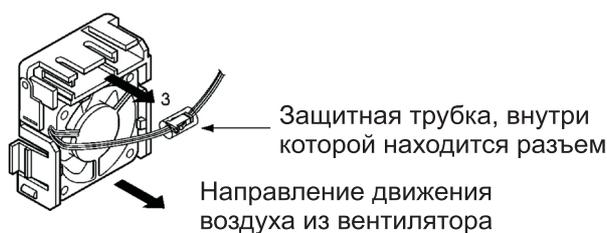
3. Снимите защитную трубку и вытащите внутренний разъем.
