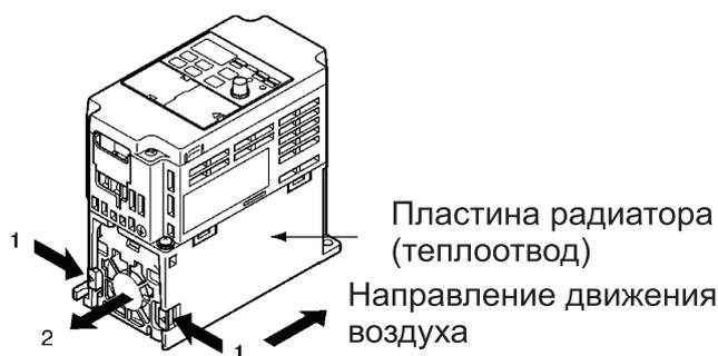
2. Удерживайте провод вентилятора и потяните защитную трубку крышки в направлении, указанном стрелкой 3.
